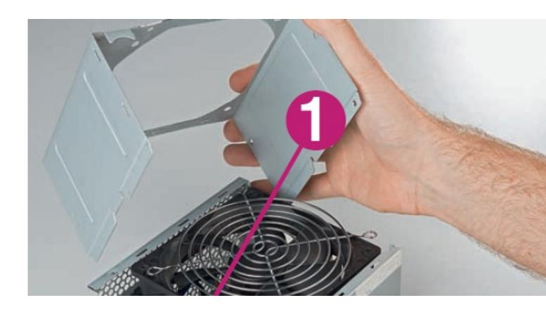
1) Открываем корпус. Если вентилятор блока питания начал сильно шуметь, смажьте его или замените аналогичным по характеристикам корпусным вентилятором, выбрать который вы можете на свое усмотрение. Открутите несколько винтов, держащих крышку блока питания, и снимите ее. Отвинтите вентилятор, изучите его маркировку и позаботьтесь о покупке нового, рассчитанного на такие же напряжение и силу тока, что и старый (их значения обычно указаны на маркировке).
