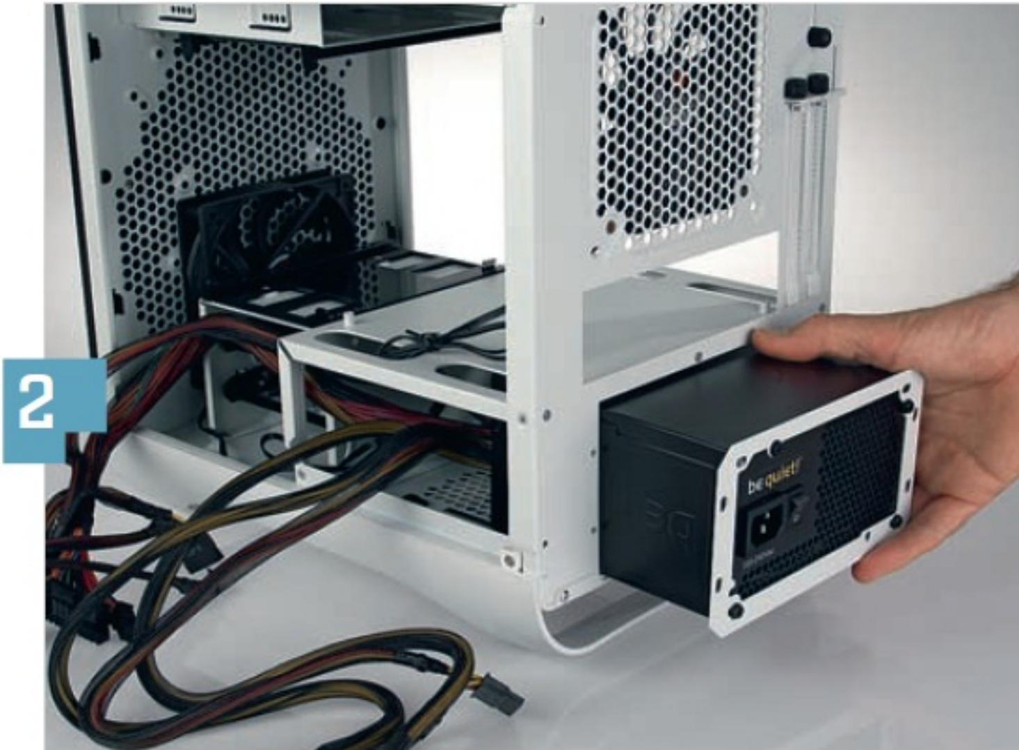
**2. Сборка компонентов.** Если точно выполнять указания руководства пользователя к корпусу BitFenix Prodigy, то проблем при сборке компьютера возникнуть не должно. Следует учесть, что блок питания лучше всего установить вентиляционным отверстием вниз, а жесткие диски вставляются в корпус вместе с салазками разъемами вперед.
